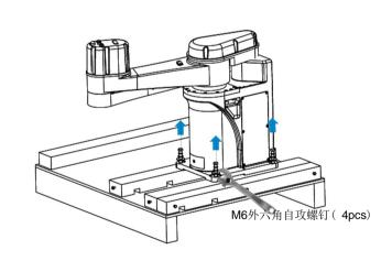
步骤1 用活动扳手拆除底座固定螺钉。
