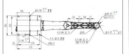
步骤1 根据基座尺寸设计并准备安装孔位。
