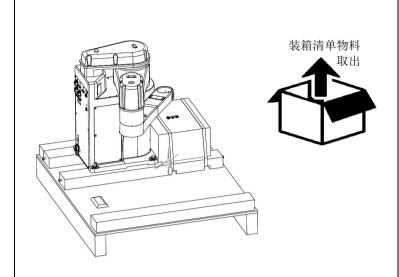
步骤1 用剪刀剪断配件箱扎带并取下。 步骤2 取出配件箱中装箱清单物料, 并根据装箱清单进 行核对。
